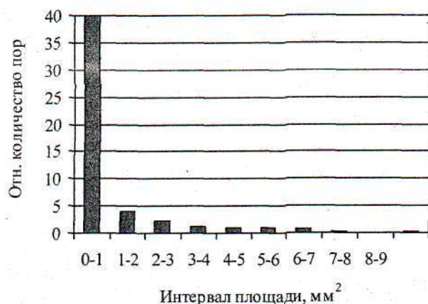
Рисунок 5. Диаграмма распределения пор по площади в сечении губчатого титана
